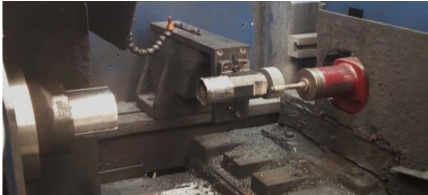
Figura 4. Proceso de rectificado de diamante.
